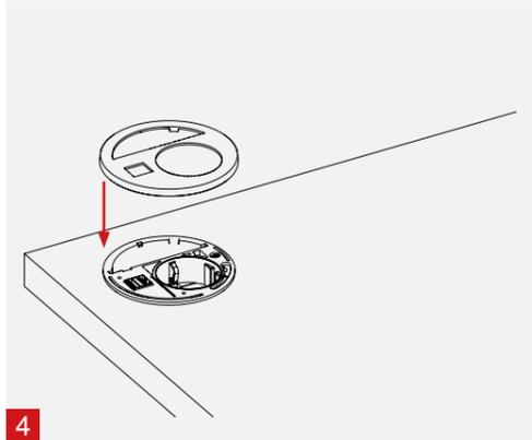
Kabeldurchlass | Cable Outlet | Passage de câble
